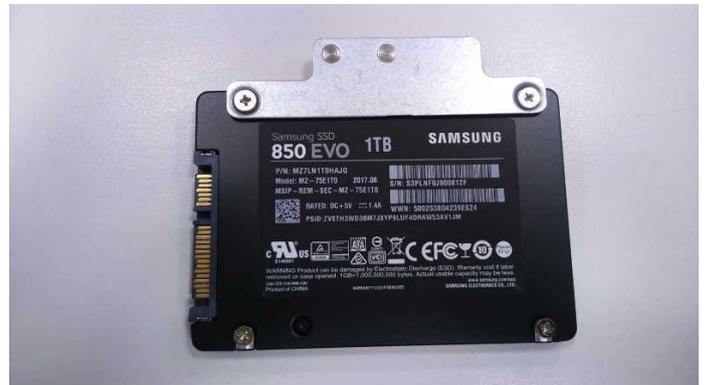
Los siguientes pasos son como los anteriores pero en sentido inverso, conexión de cableado (fijándose en la posición del conector que tiene forma de L), inserción en de SSD en chasis apoyándose en el propio chasis, encajar los pivotes del lado opuesto y por último apretar los tornillos que se apoyan en el chasis. Volvemos a colocar la tapa de nuestro Teknopack y ya estará realizado el trabajo.
