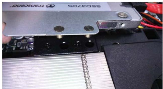
Tirando del SSD se desenchaja fácilmente de las ranuras del chasis que la que le hacen de soporte. El SSD sólo está conectado al Teknopack por el cable SATA y el cable de alimentación, los cuales procederemos a su extracción sujetando firmemente el SSD y tirando del conector del cable.
