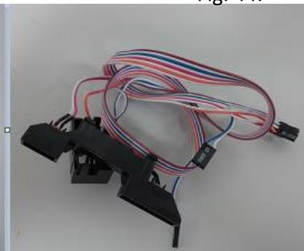
Le plastique et les câbles peuvent être séparés dans le support LED. Pour ce faire, ouvrez les prises et tirez les câbles, fig 45, fig 46 :
