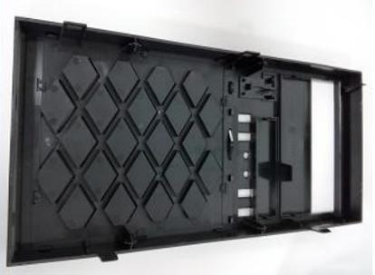
Une fois l'extrémité avant enlevée, il est facile d'enlever les deux autres petites extrémités avant. Il suffit d'utiliser les doigts pour plier les douilles, Fig. 37 et Fig. 38.
