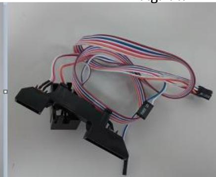
El plástico y los cables se pueden separar en el soporte del LED. Para hacer esto hay que abrir los encajes y tirar de los cables, fig 45, Fig46:
