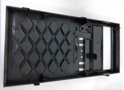
Una vez que el frontal delantero está desmontado, es fácil sacar los otros dos frontales de menor tamaño. Sólo tiene que utilizar los dedos para doblar los encajes, Fig. 37 e Fig. 38.
