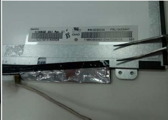
Utiliser la pincette pour retirer la protection en plastique du circuit. Dévisser les petites vis et tirer la pièce. Le résultat se trouve sur les Fig. 18 et 19.
