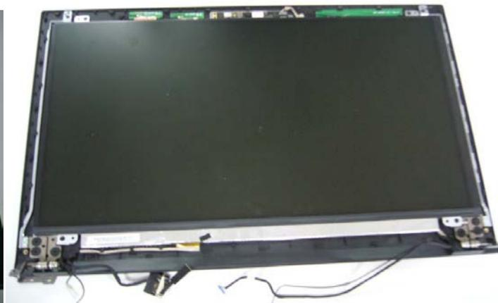
Dans les coins inférieur et supérieur de la Fig.13 il y a quelques vis. Dévissez-les pour séparer l'unité LCD Fig. 15 et Fig. 16, le résultat se trouve à la Fig. 17.
