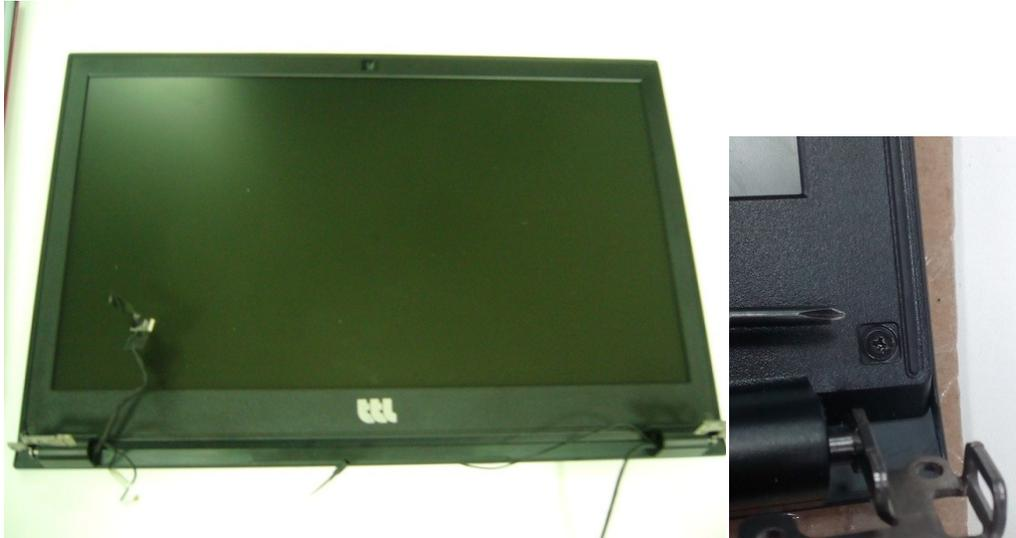
En bas à droite et à gauche de la Fig. 11, il y a deux vis. Dévissez-les pour retirer le couvercle en plastique, Fig.12, le résultat est Fig.13.
