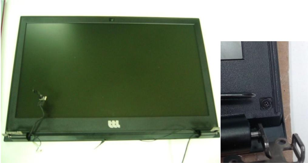
En la parte inferior derecha e izquierda de la Fig. 11 hay dos tornillos. Destornillarlos para extraer la cubierta plástica, Fig.12. El resultado es la Fig.13.
