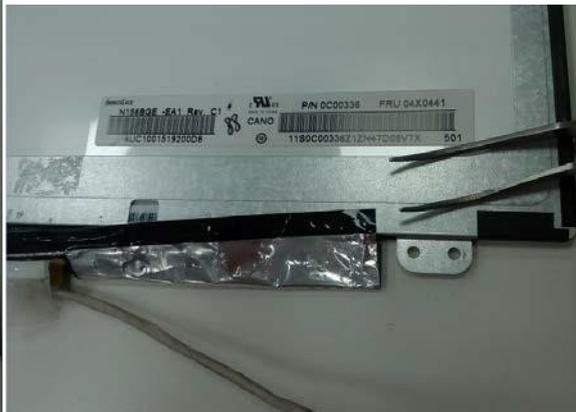
Utilice las pinzas para eliminar la protección de plástico del circuito. Desenrosque los tornillos pequeños y tire de la pieza. El resultado se encuentra en las Fig. 18 y Fig. 19.
