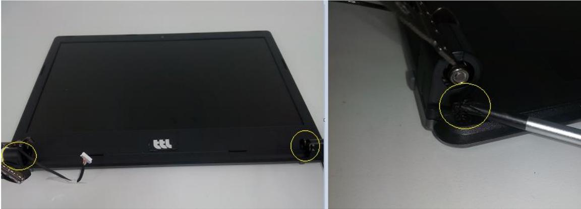
En la parte inferior derecha e izquierda de la Fig. 18 hay dos tornillos. Desenrosque para sacar la cubierta de plástico frontal Fig. 19. El resultado es la Fig. 20.
