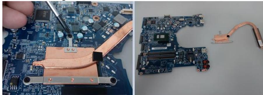
Para el ventilador, hay que quitar los tornillos y desconectarlo del adaptador, Fig. 13:
