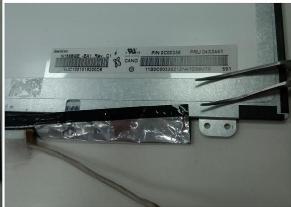
Use el destornillador para eliminar el circuito de protección de plástico.
