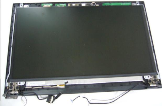
En la esquina inferior y superior de la Fig. 20 allí nos algunos tornillos fijos. Desenróllelos para separar la unidad LCD de su sustrato de plástico fig.21 y Fig. 22. El resultado es la Fig 23.
